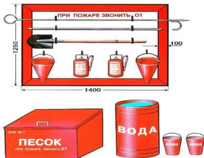
Рисунок 6 - Пожарный щит первичных средств пожаротушения
