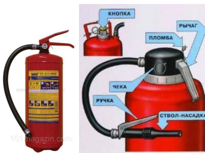
Рисунок 12 – Порошковый огнетушитель ОП-5
